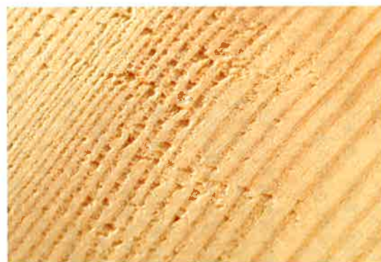
▲通常鉋胴にて荒取り後、仕上げ切削
