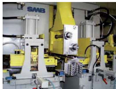
SMB社 大断面集成材用コンパクトフィンガー
